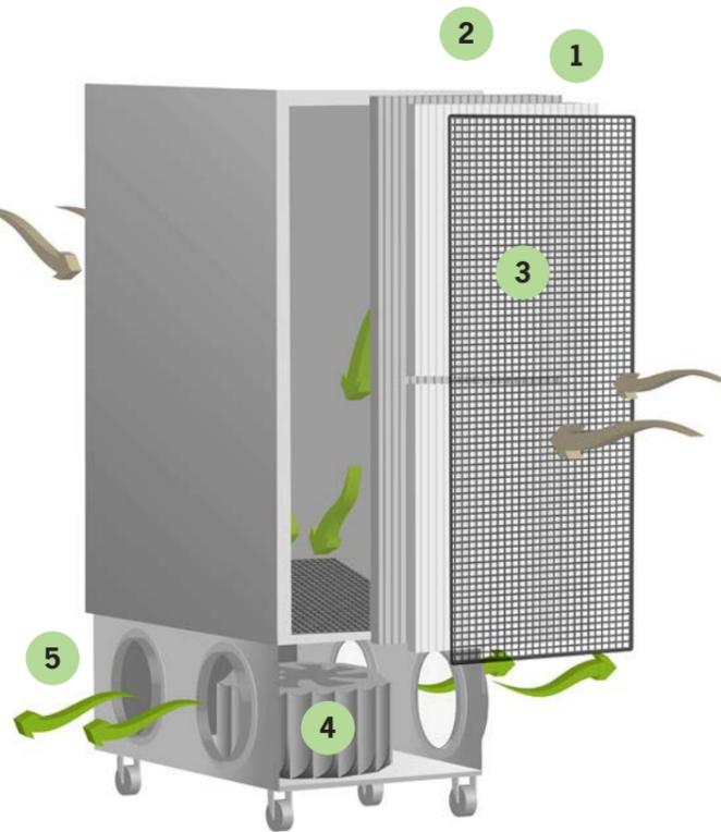
4. La única parte móvil en un purificador de aire es el ventilador. El ventilador está ubicado debajo de los filtros y crea una presión uniforme baja en la columna de aire purificado posterior a los filtros.
