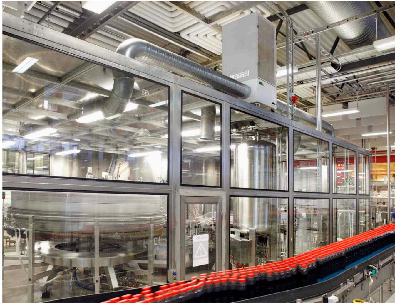
La imagen muestra una planta de embotellado que requiere una elevada cantidad de aire limpio detrás de las superficies acristaladas. El aire del exterior entra en el purificador y pasa a través del filtro HEPA de alta eficacia antes de ser dirigido a la planta de embotellado.
